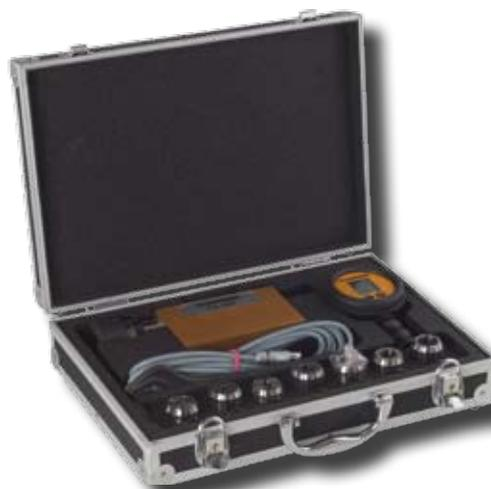
Для быстрого, удобного и прямого контроля существующего давления и расхода СОЖ для инструмента с внутренним охлаждением фирма Gühring разработала прибор контроля PQ3000. Проверка производится
