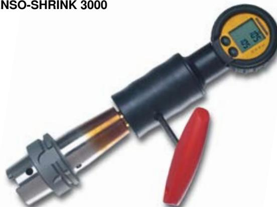
SENSO-SHRINK 3000 определяет усилие зажима просто, быстро и точно благодаря измерению размера отверстия. В качестве результата измерения SENSO-SHRINK 3000 показывает процентное отклонение от заданного значения базового патрона.
