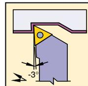
TN . . 60° углом пластины требует державку MTJN с обратным углом наклона 3°
