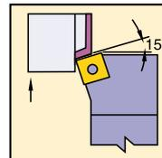
SN . . 90° углом пластины требует державку MSKN с углом наклона 15°
