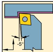
CN . . 80° углом пластины требует державку MCLN с обратным углом наклона 5°
