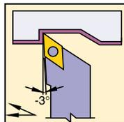
DN . . 55° углом пластины требует державку MDJN с обратным углом наклона 3°
