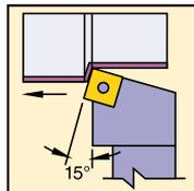
SN . . 90° углом пластины требует державку MSRN с углом наклона 15°
