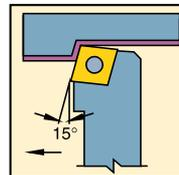
CN . . 100° углом пластины требует державку MCRN с углом наклона 15°
