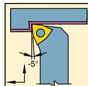
WN . . 80° углом пластины требует державку MWLN с обратным углом наклона 5°
