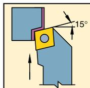
CN . . 100° углом пластины требует державку MCKN с углом наклона 15°
