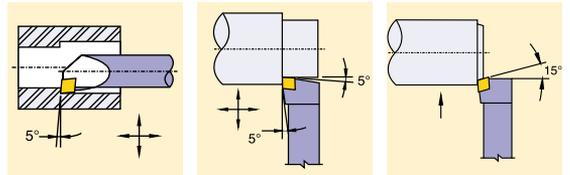
C.M.T 80° пластины требуют державку SCL с обратным углом наклона 5°
